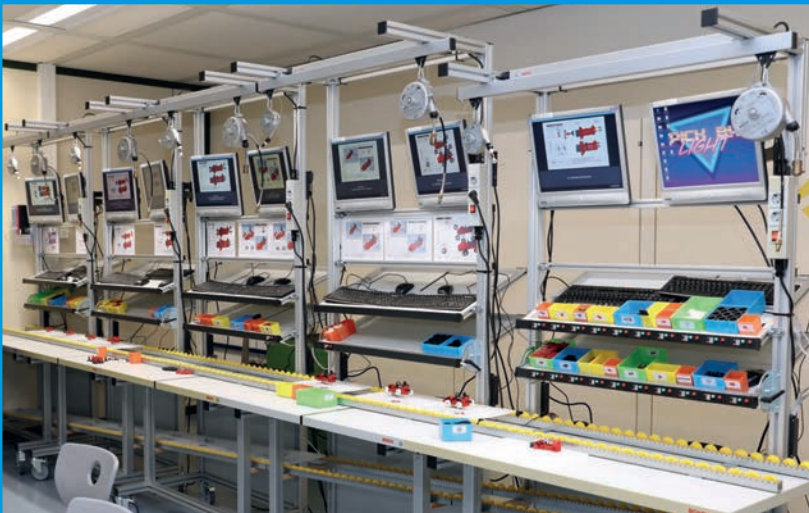
Montagelinie mit Pick-by-Light System. (Foto: Ronald Neesse)
